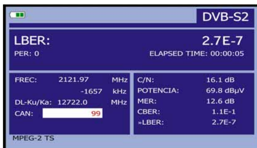
Figura 38.- Pantalla de medida del LBER de señales moduladas en QPSK/8PSK. (DVB-S2).
