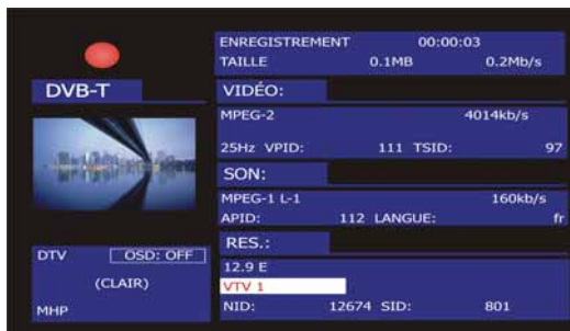
Figure 68.- Enregistrement d'un canal numérique.
