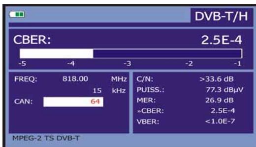
Figure 31.- Écran de mesure du CBER de signaux modulés en COFDM.
