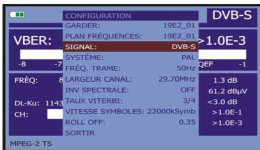
Figure 21.- Écran de configuration de mesure de signaux modulés en QPSK.
